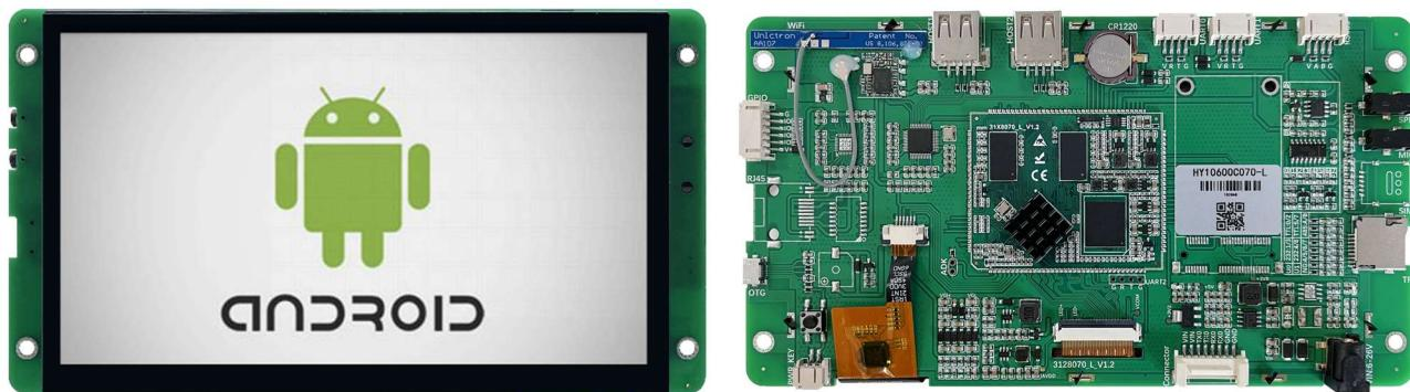
HY10600L070\_STD\_V1.2, 是一款基于 Rockchip RK3128 ARM 处理器的工业级安卓串口液晶屏。该产品集成了 Rockchip RK3128 的优良特性，搭载四核 Cortex-A7 方案，支持 1080p@60fps 下的大多数主流解码方案，1080p@30fps 下的 H.265/H.264/MVC/VP8 解码方案。同时，良好的 JPEG 图片处理性能和 3D GPU 让该平台兼容支持 OpenGL ES 2.0，OpenVG1.1。
