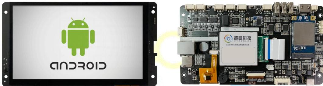
HY10600H070\_STD\_V5.0, 是一款基于 Rockchip RK3188 ARM 处理器的工业级安卓串口液晶屏。该产品集成了 Rockchip RK3188 的优良特性, 搭载四核 Cortex-A9 方案, 支持 1080p@60fps 下的大多数主流解码方案, 1080p@30fps 下的 H.265/H.264/MVC/VP8 解码方案。同时, 良好的 JPEG 图片处理性能和 3D GPU 让该平台兼容支持 OpenGL ES 2.0, OpenVG1.1.
